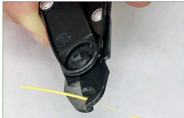
2 Asportare il rivestimento della fibra con la pinza Miller.
