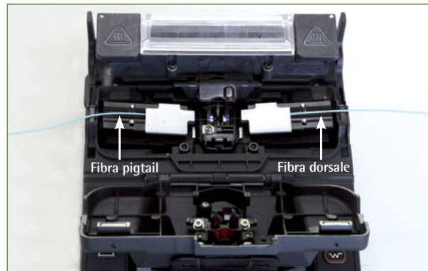
4 Posizionare la fibra di dorsale e la fibra del pigtail.
