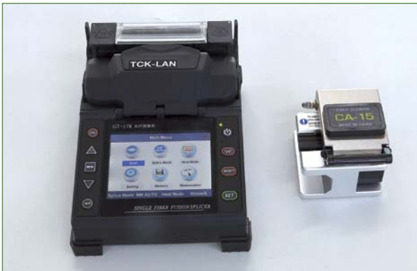
1 Attrezzatura necessaria per la realizzazione del giunto a caldo.
