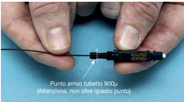
11 Avvicinare il rivestimento da 900 µ e inserirlo nel connettore a battuta.
