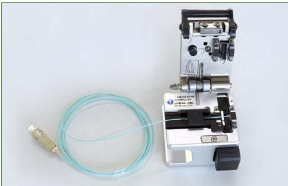
3 Posizionare la fibra, abbassare il blocco e spingere il carrello per tagliare la fibra.
