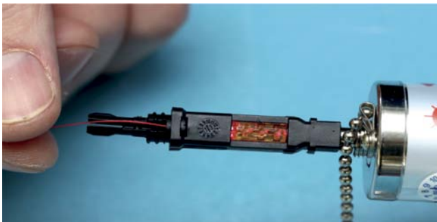
9 Inserire la fibra tagliata nel connettore in modo da vedere la luce rossa nel V-Groove attenuarsi di intensità (questa operazione conferma l'avvenuto accoppiamento delle fibre).
