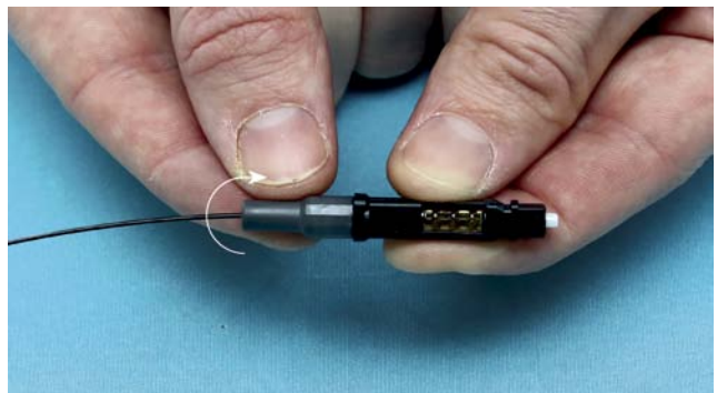
12 Avvitare il boot sul corpo connettore per bloccare la fibra.
