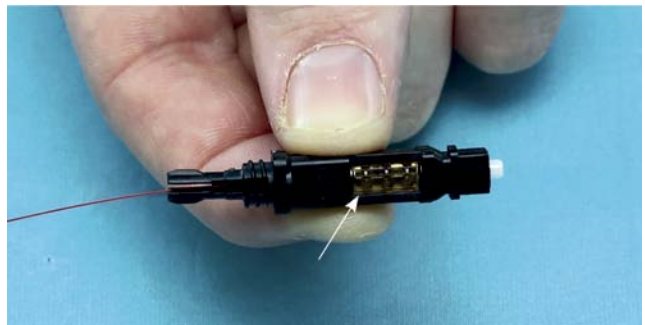
10 Schiacciare il V-Groove come indicato dalla freccia in modo da bloccare le fibre.
